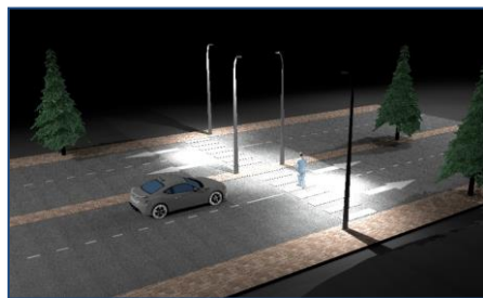
Figura 25 – Iluminação adequada das travessias pedonais[24]
