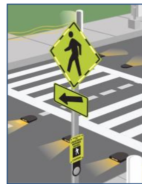
Figura 21 – Sinalização vertical com recurso a placas de LED
