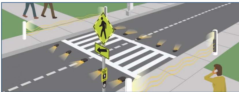
Figura 20 – Sistema moderno de iluminação transversal incorporada no pavimento [20]
