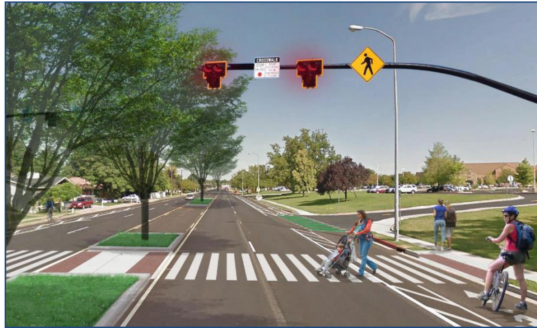
Figura 22 – Solução de faróis intermitente para alerta dos condutores para a presença de peões nas travessias pedonais [22]
