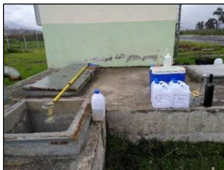
Figura 76. Recolección manual de muestra de agua residual a la entrada de la PTAR (Cámara de desbaste).
