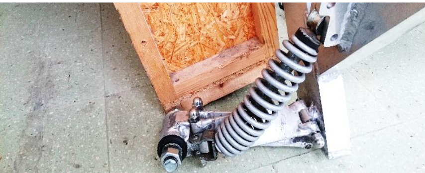
35. Amortecedor empenado após acidente
