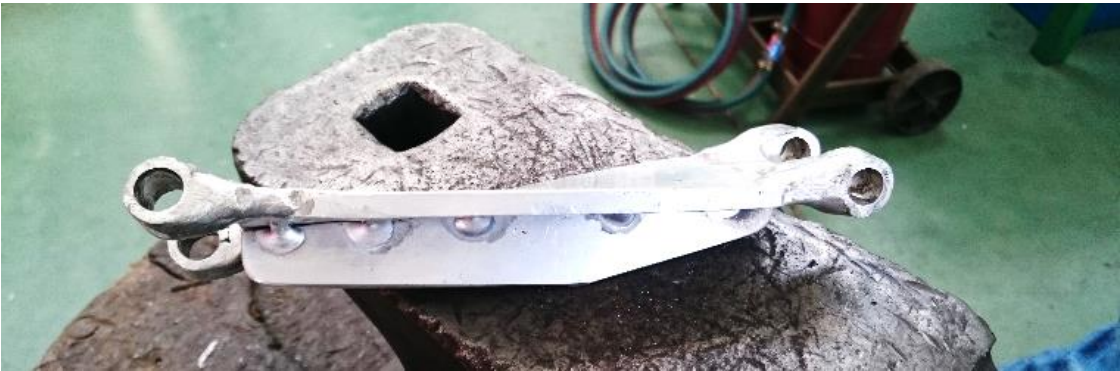
34. Barras estabilizadoras empenadas após acidente
