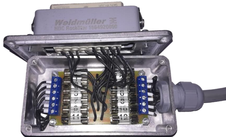
Figura 4.63 – Caixa de Fusíveis Aberta
