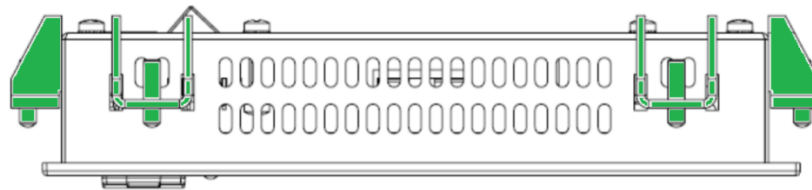
Figura 4.12 – Fixação da ETT731
