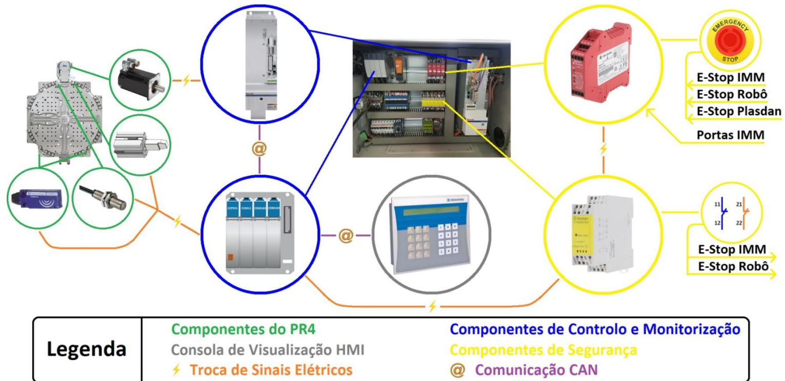
Figura 3.5 – Interligação dos Componentes na Solução Atual (PR4)
