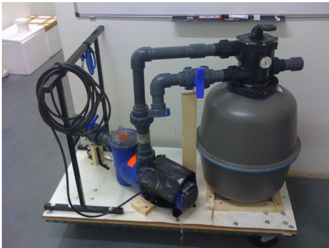
Figura 2.20 – Sistema de sifonagem móvel (Foto de: Miguel Paiva)
