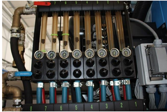
Figura 113 - Sistema de controlo das temperaturas de funcionamento do molde.
