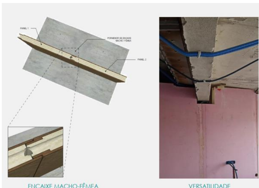
Figura 53- Pormenores de conexão dos painéis. Fractus. 2023.
