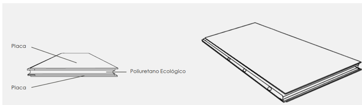
Figura 6- Esquema de composição do painel Fractus. Fractus. 2023
